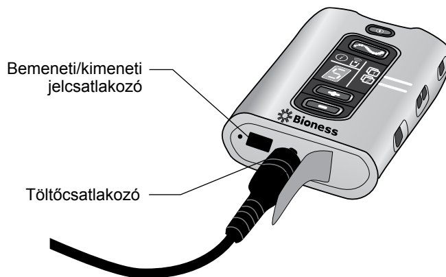
4-8. ábra: A H200 Wireless vezérlőegység töltőcsatlakozója
