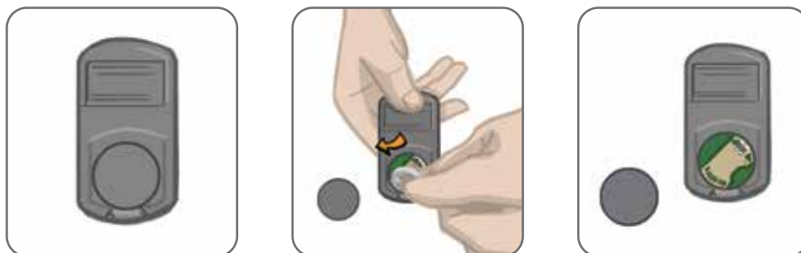
Obrázek 8-2: Výměna baterie řídicí jednotky
