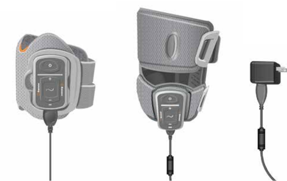
Obrázek 6-2: Nastavení nabíjení systému L300 Go (příklad konfigurace manžety pro dolní část nohy a manžety pro stehno)
