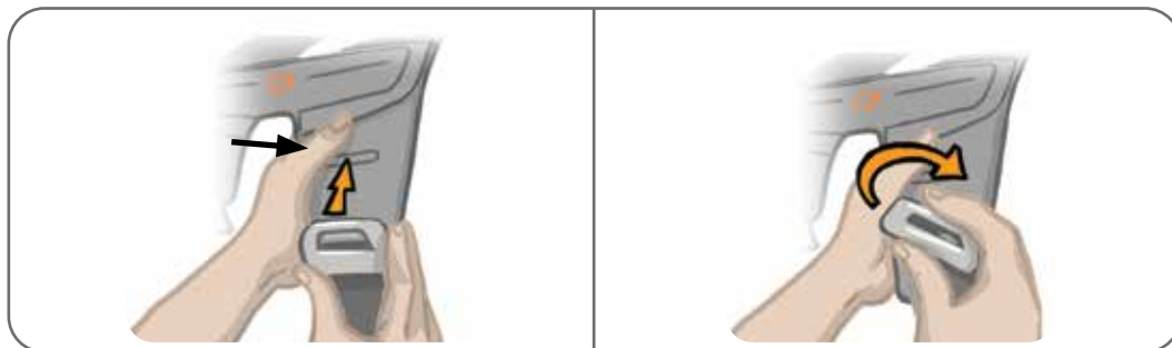
Figura 8-13: Îndepărtarea benzilor pentru coapsă
