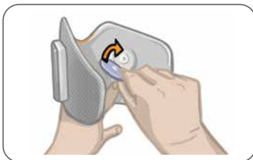
Obrázok 8-5: Nasadenie látkových elektród
