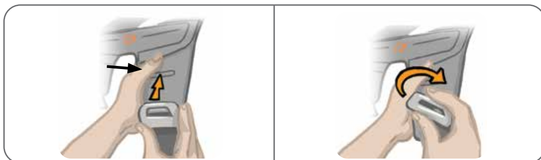
Obrázok 8-13: Odstránenie popruhov na stehno
