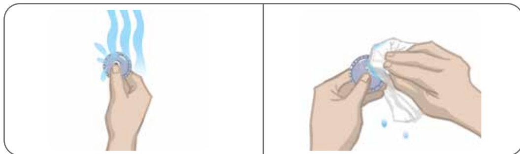
6-5. ábra: Az elektróda nedvesítése és a felesleges víz eltávolítása
