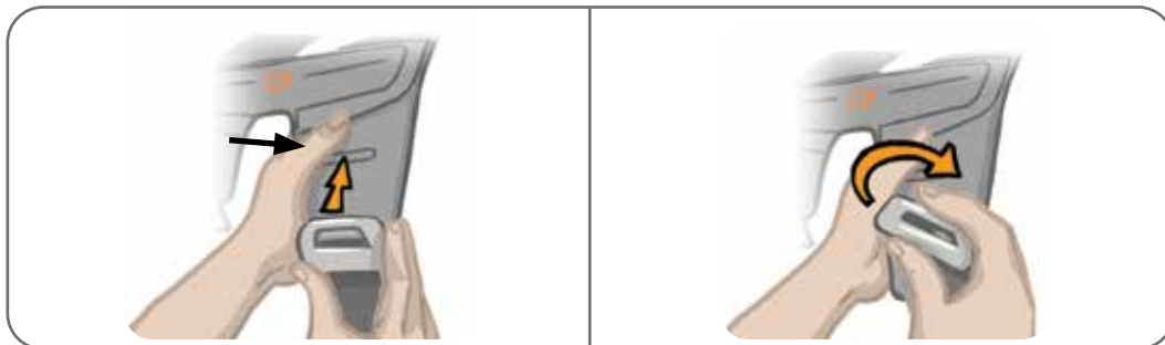
8-13. ábra: A combszíjak eltávolítása
