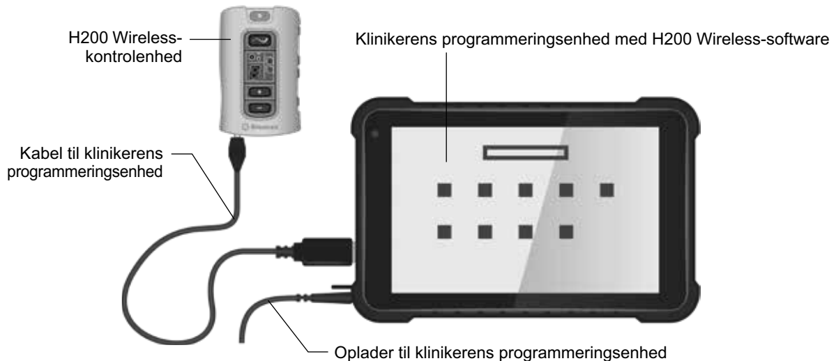
Figur 7-1: Opladningskonfiguration for klinikerens programmeringsenhed
