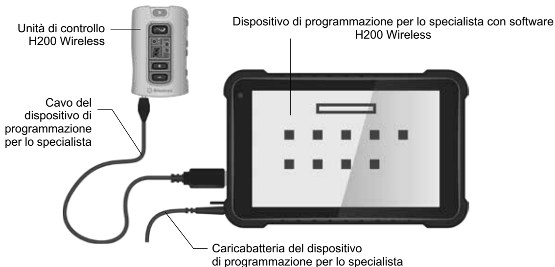
Figura 5-1 - Componenti del dispositivo di programmazione con l'unità di controllo H200 Wireless collegata
