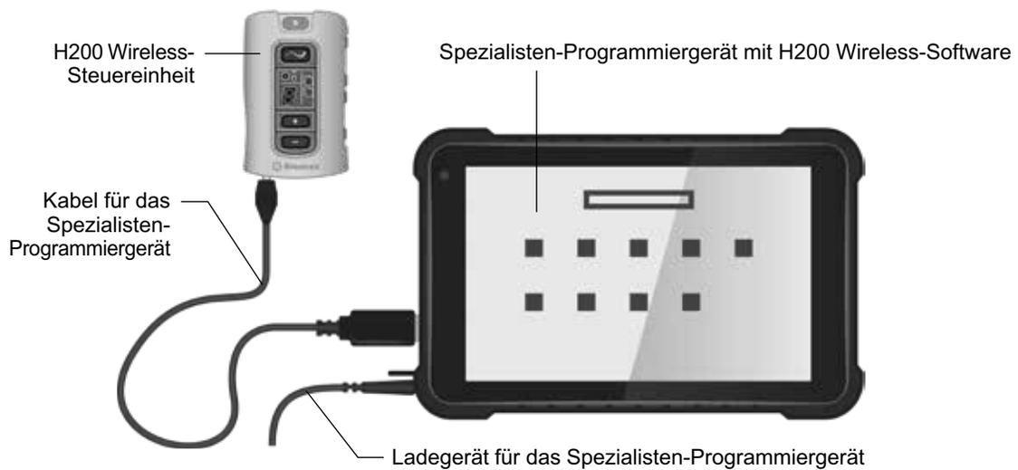
Abbildung 5-1: Komponenten des Spezialisten-Programmiergeräts, H200 Wireless-Steuereinheit angeschlossen
