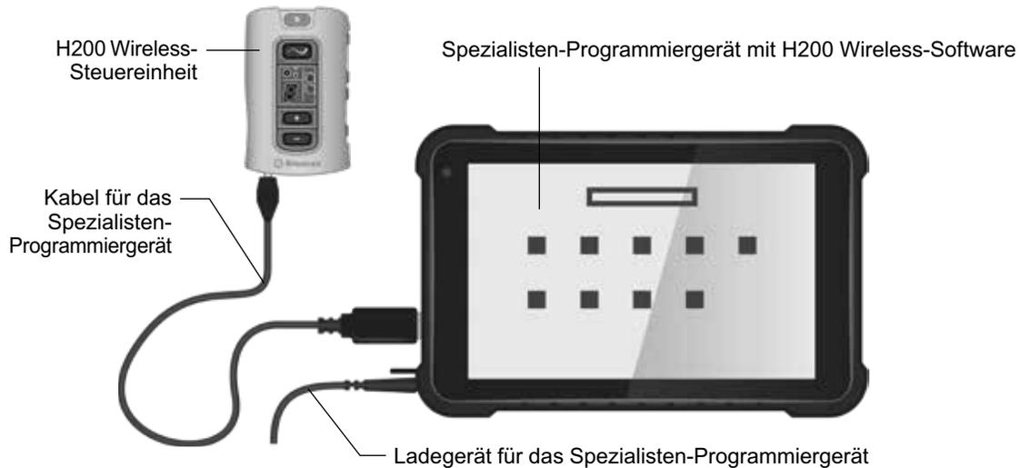
Abbildung 7-2: H200 Wireless-Steuereinheit an das Spezialisten-Programmiergerät angeschlossen
