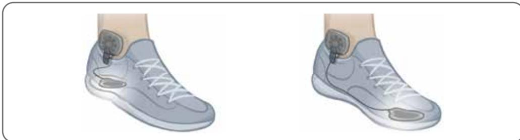
Figura 6-19: Posição final do sensor de pé preso ao sapato
