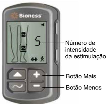
Figura 7-2: Ajuste da intensidade da estimulação
