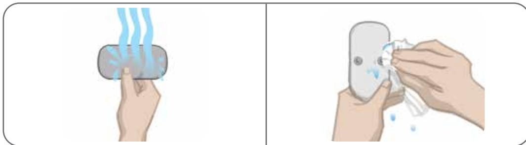
Figura 6-9: Molhe o eletrodo e remova o excesso de água
