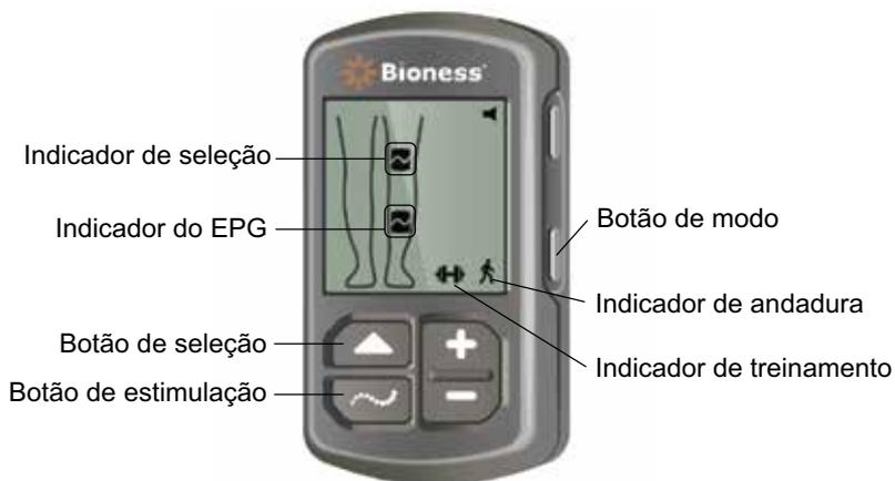
Figura 7-1: Seleção de um modo de operação na unidade de controle
