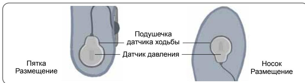
Рисунок 6-18. Размещение датчика стопы в обуви.
