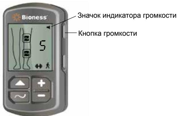
Рисунок 7-3. Кнопка громкости на блоке управления
