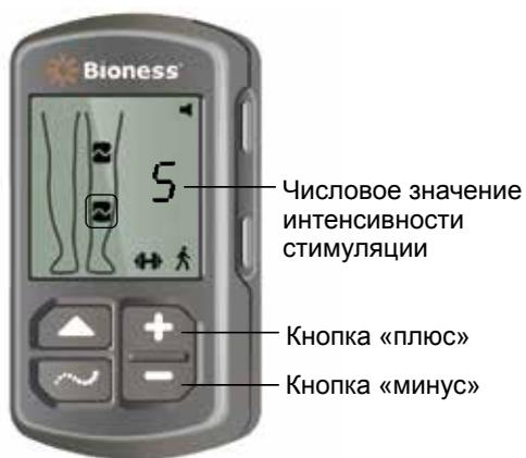
Рисунок 7-2. Регулировка интенсивности стимуляции
