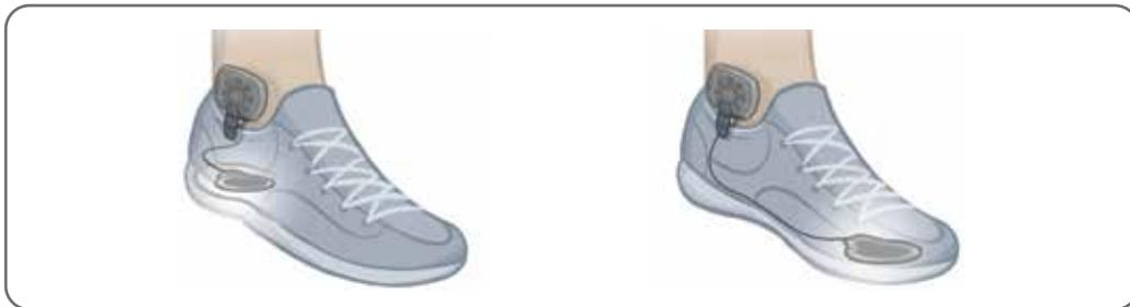
Рисунок 6-19. Окончательное размещение датчика стопы в обуви.
