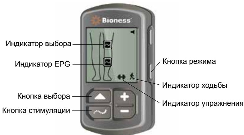
Рисунок 7-1. Выбор режима работы с помощью блока управления
