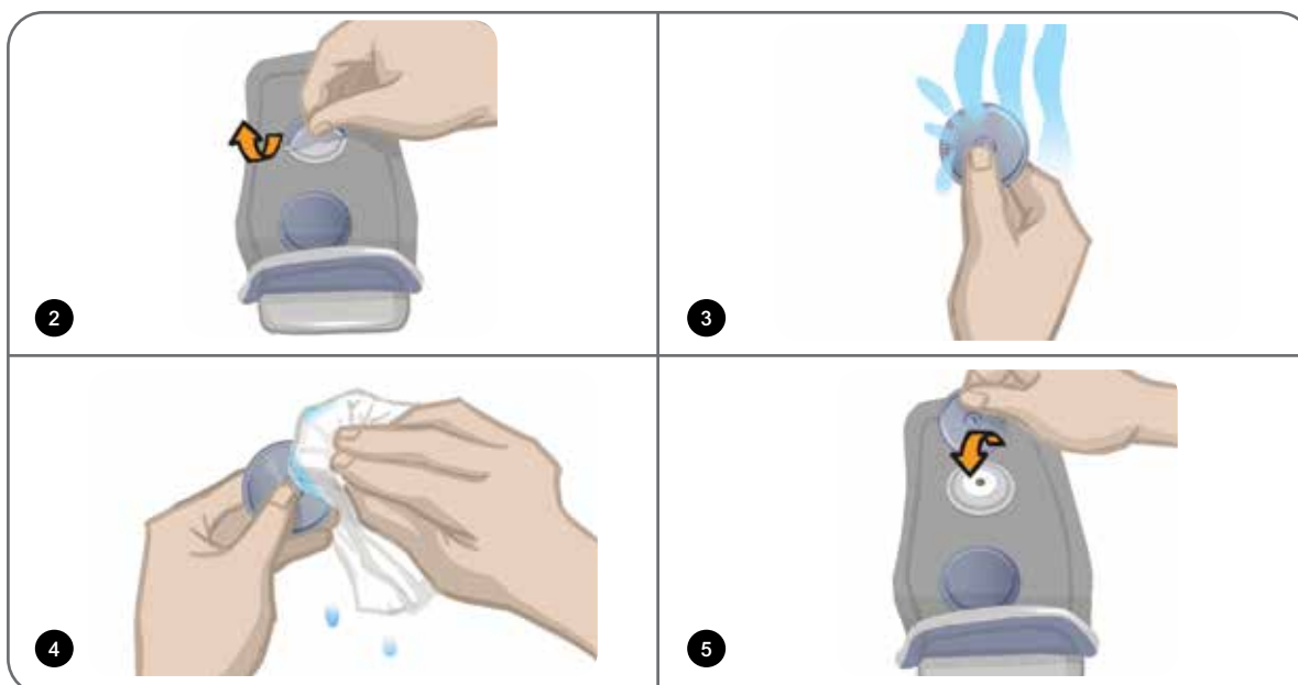
Figur 8-9: Tilpasning af de små runde tekstilelektroder
