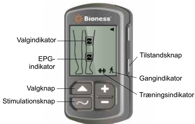
Figur 7-1: Valg af driftstilstand på kontrolenheden:
