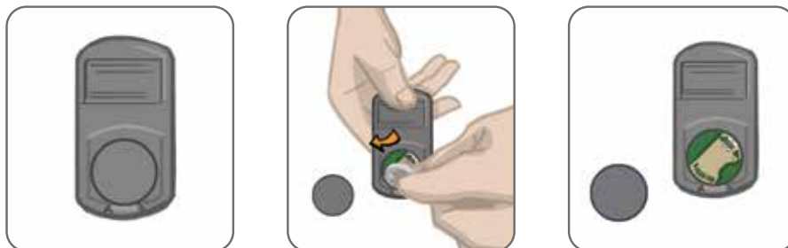
Figur 8-2: Udskiftning af batteriet i kontrolenheden
