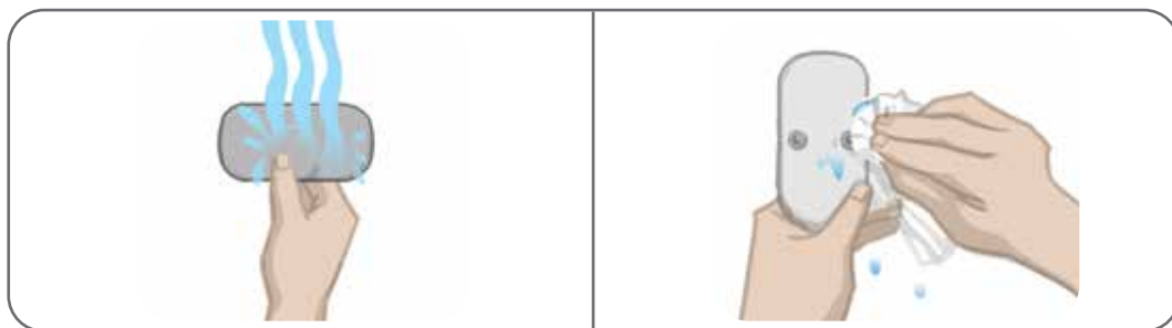
Figur 6-9: Fugtning af elektroden og fjernelse af overskydende vand
