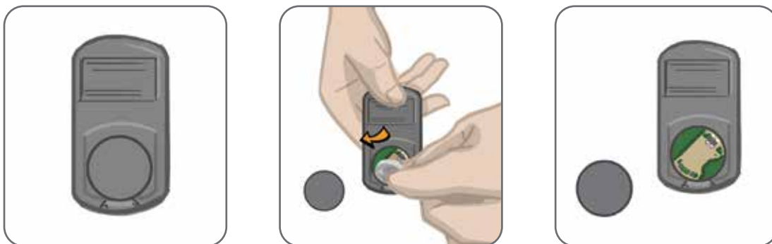
Afbeelding 11-2: De batterij van de bedieningseenheid vervangen
