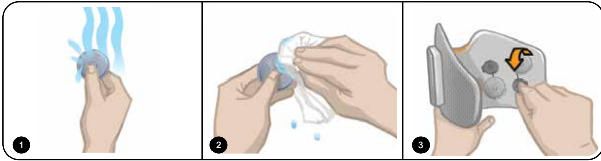
Figure 8-11 : Installation de l'électrode ronde en tissu
