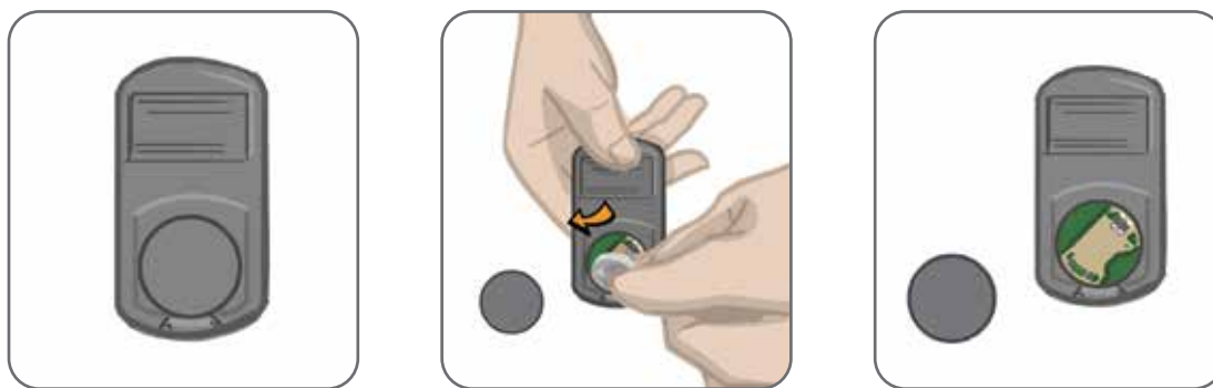
Figure 11-2 : Remplacement de la batterie de l'unité de commande
