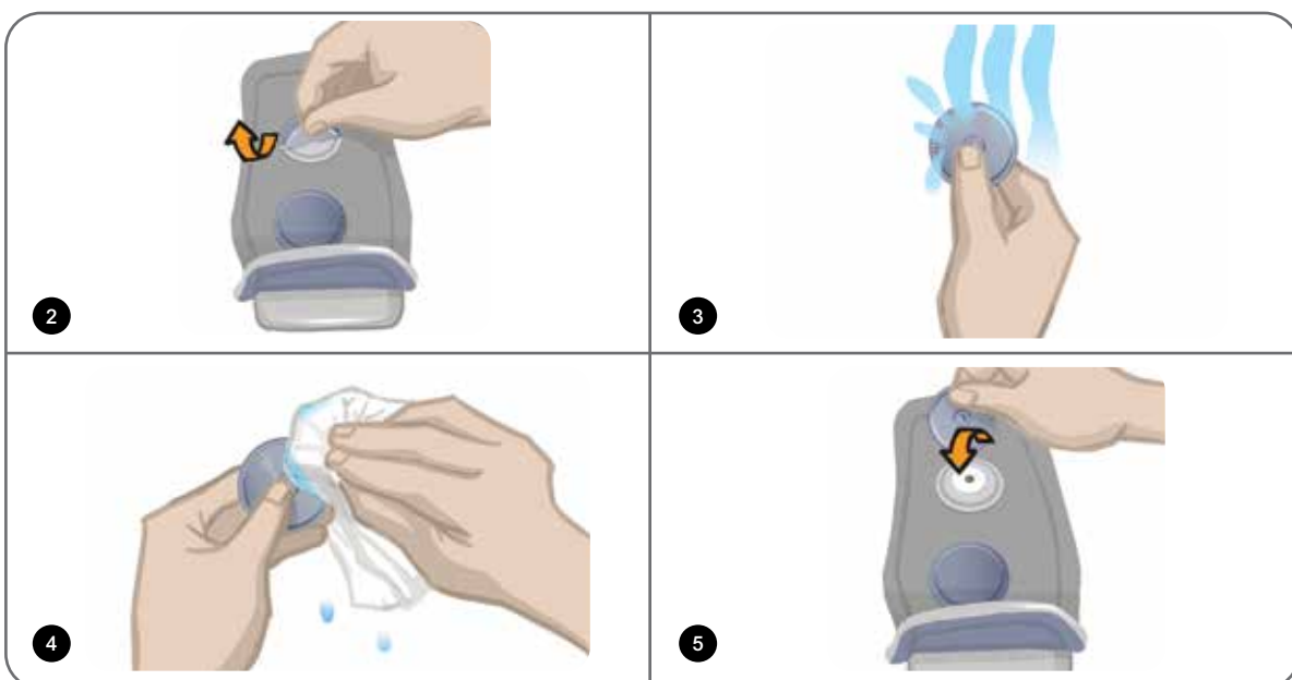
Figure 8-9 : Installation des électrodes rondes en tissu de petite taille
