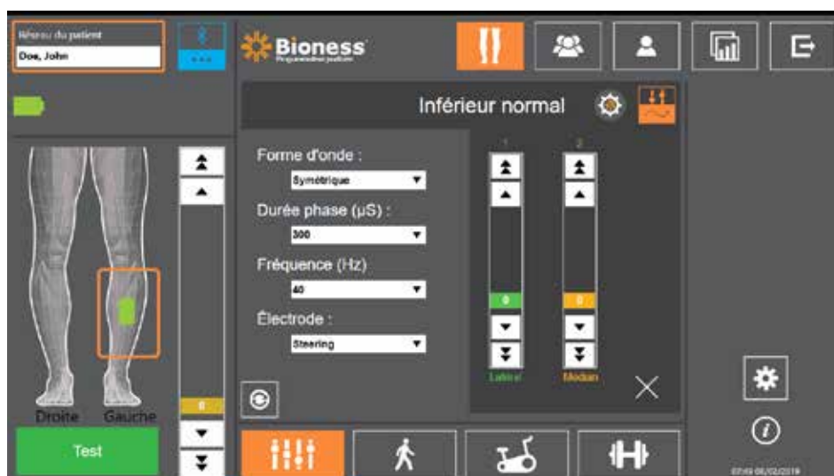
Figure 9-5 : Programmation de la stimulation, écran des paramètres avec fenêtre des paramètres avancés
