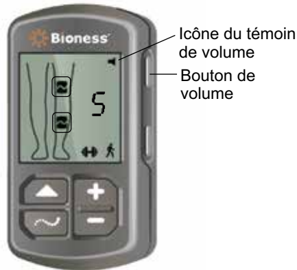
Figure 7-3 : Bouton de volume de l'unité de commande
