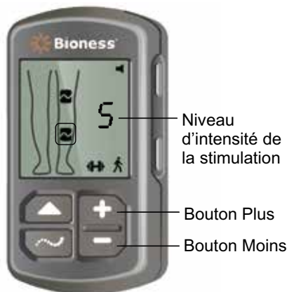
Figure 7-2 : Réglage du niveau d'intensité de la stimulation
