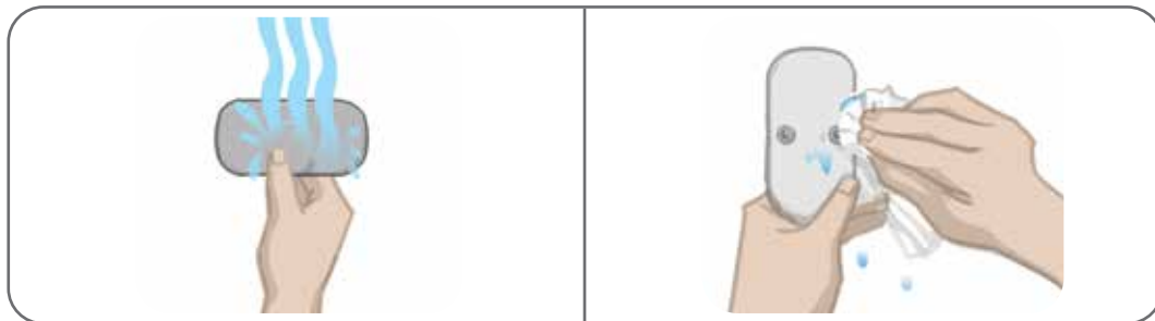
Figure 6-9 : Humidification de l'électrode et élimination de l'excès d'eau
