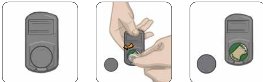
Figure 8-2 : Remplacement de la batterie de l'unité de commande
