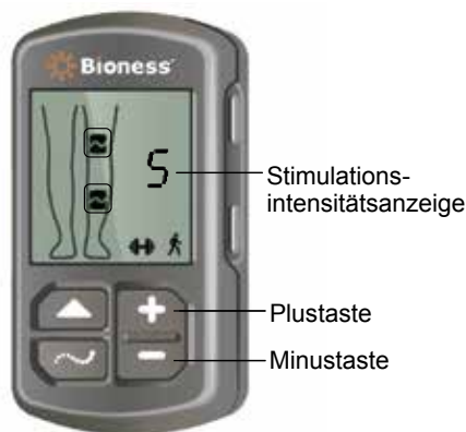
Abbildung 4-9: Einstellen der Stimulationsintensität
