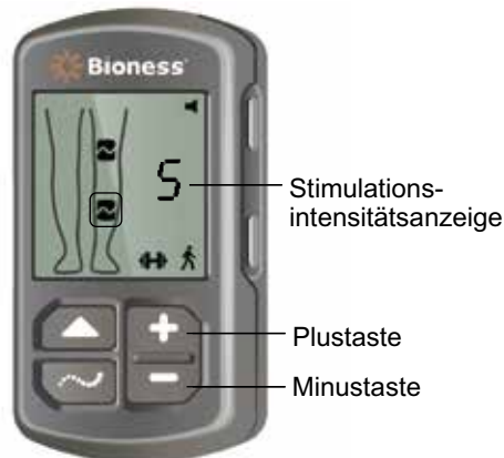
Abbildung 7-2: Einstellen der Stimulationsintensität
