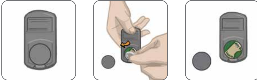
Abbildung 8-2: Austauschen der Batterie der Steuereinheit
