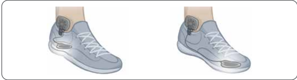
Abbildung 6-19: Position des am Schuh befestigten Fußsensors
