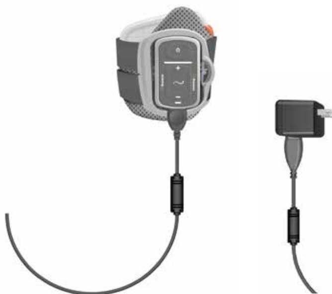
Figure 4-7 : Configuration du chargement du système L100 Go
