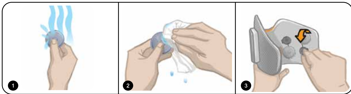
Figure 8-10 : Installation des bases d'électrodes rondes en tissu
